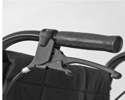
Bremse angezogen und verriegelt
